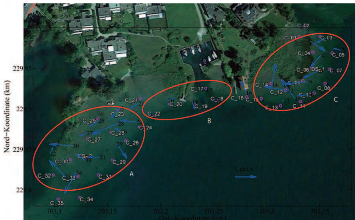
Сл. 6. Хоризонтално решено струјно поље на локацији Фрајенбах-Хурден «Сифелд»: А велика брзина струје и ерозија, Б ниска брзина струје и акумулација седимента, Ц динамичко струјно поље и велики потенцијал ерозије. Илустрација: Одељење Подводне археологије Цириха, Канцеларија за Урбанизам
