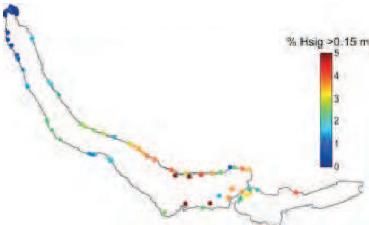
Сл. 17, Годишња средња (2018) изложеност таласима локација око Циришког језера. Експозиција је приказана као релативна фреквенција значајне висине таласа H_{sig} > 0,15 м. Илустрација Х. Хофманн.
