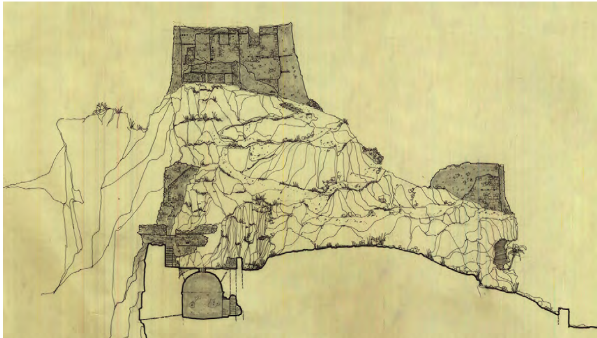
Попречни пресек горњег града из 1968. године, виде се цистерна за воду са северним бедемом, део јужног бедема и донжон кула, документација ЗЗСК Ниш
